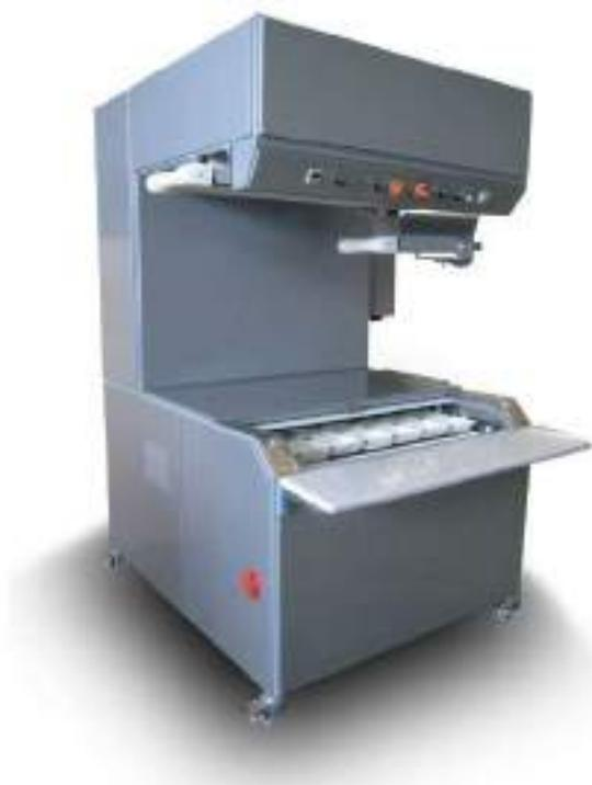
Charge manuelle et décharge automatique sous façonneuse intégrée ou sortie latéral sous façonneuse droite ou gauche.
